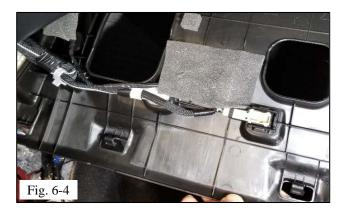
(d) Apply foam tape to bundled wire harness and connector (Fig. 6-4).
